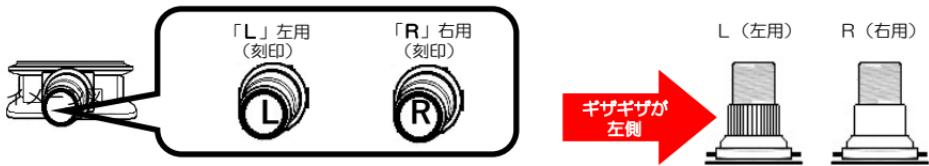
③ペダルの取り付けは、はじめに手で締められるところまで締めた後、スパナ/付属の専用工具等でしっかりと本締めして、がたつき等がないか確認をして下さい。
