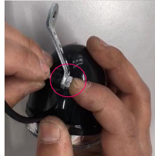
②ライトとフロントフォークライトステーをボルトナットを使い、取り付けます。(部品取り付け順序はボルト、スプリングワッシャー、ライト側接続ボルト、ギザワッシャー、フロントフォークライトステー、ナット)
